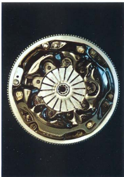
Solfjäderskoppling ger lågt pedaltryck
