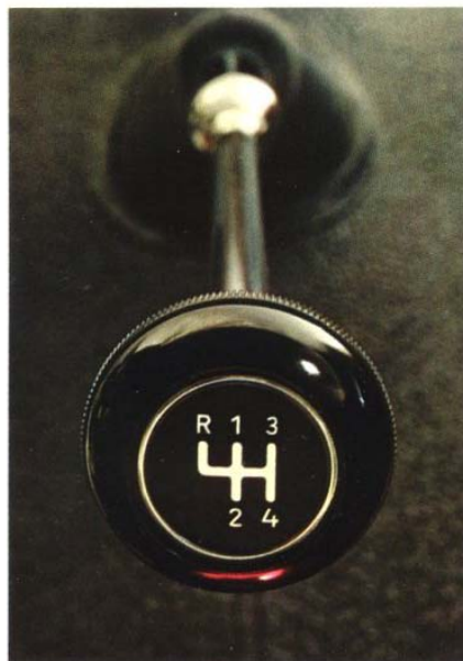
Golvväxelspak med distinkta lägen
